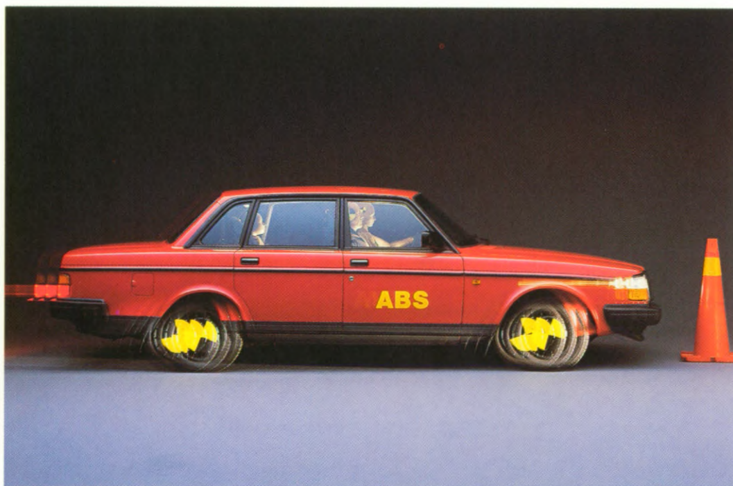
ABS is als optie verkrijgbaar en dit elektronisch gecontroleerde remsysteem voorkomt dat de wielen blokkeren. Uw Volvo 240 blijft daardoor onder alle omstandigheden bestuurbaar, ook als u plotseling moet remmen.
