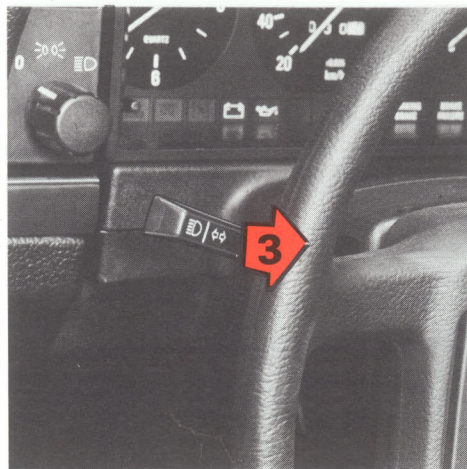
Conmutador luces largas y de cruce
