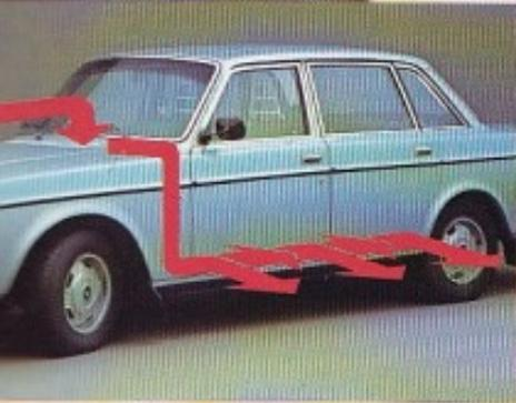
Les seuils de portes sont à l'abri de l'humidité par un courant d'air permanent. La partie inférieure est traitée avec du polyester.
