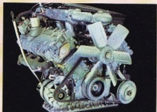
Le bloc-moteur et la culasse sont en alliage léger. On a recours à un allumage transistorisé sans rupteurs pour un fonctionnement sans problèmes.
