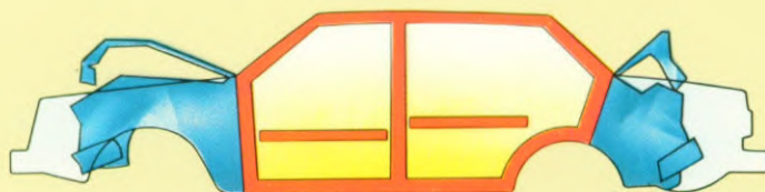
De Volvo 264 heeft een sterke carrosserie, waarvan de voor- en achterkant als energie-absorberende zones fungeren. De inzittenden zijn beschermd door een vrijwel onwrikbare kooiconstructie, terwijl stalen balken in de deuren bescherming bieden bij een eventuele aanrijding van opzij.
