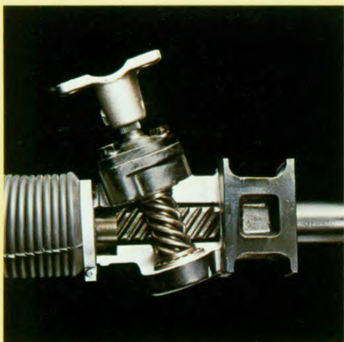
Tandheugelbesturing voor precisie en richtingstabiliteit.
