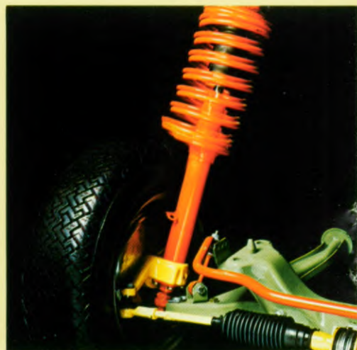
De Mc. Pherson-voorwielophanging draagt bij tot een uitstekende wegligging en groot veercomfort.
